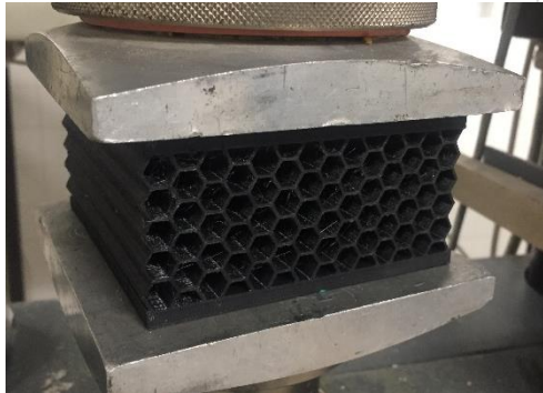
Figura 67 – Dissipador de geometria honeycomb , em PETg (facultado pelo coorientador científico).
