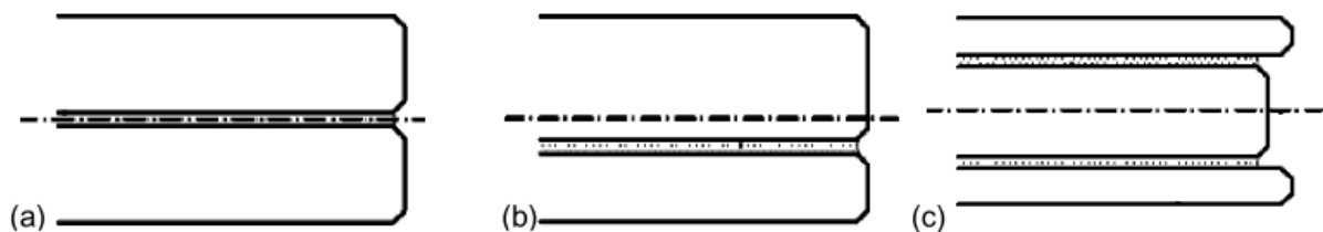
Figura 25 – Vidros laminados de diferentes dimensões na espessura total (adaptado de [36]).
